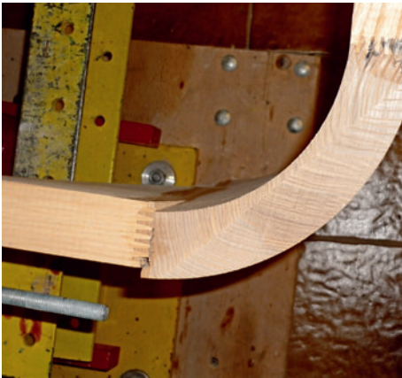
! Hier werden 40-mm-Krümmlinge im Prüfstand umfassend und intensiv mit Blick auf unterschiedlichste Belastungen geprüft. (Foto: DHTI)
