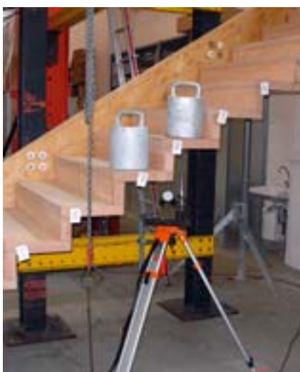
Für die „Europäisch technische Zulassung“ waren Berechnungen und Belastungsversuche erforderlich. Bild: Prof. Achim Irle
