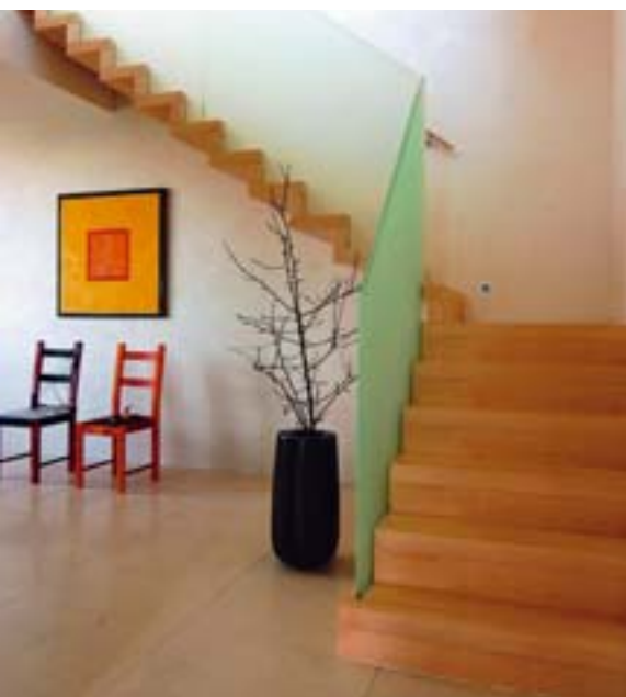
Fast frei schwebend erscheinende Faltwerk-treppe mit transparentem Geländer. Bild: BK-Treppen Bernd Kunze, Wilnsdorf
